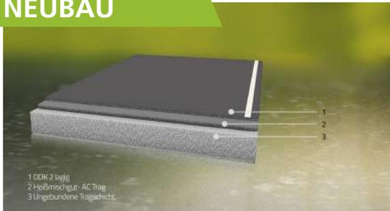
Auf Grund seiner hervorragenden Eigenschaften wird zukünftig der Einsatz von **DDK/DSK** im **Straßenneubau** unabdingbar, die Achslasten steigen immer weiter und die Asphaltbauweise braucht dicke, kraftschlüssige Tragschichten und dünne, verformungsresistente, griffige und schützende (abdichtende) Deckschichten wie den **MIKROBELAG®**.
