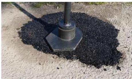
Zur fachgerechten und manuellen Verdichtung von **REPHALT®** und **KALTMISCHGUT** bei Kleinflächensanierung. Gelenkschonend durch Gummipuffer.
