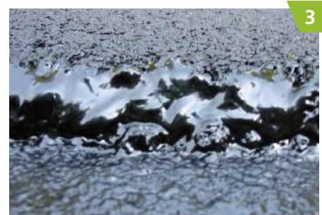
Zeitabhängig von der jeweiligen Außen-temperatur kann nach dem Durchtrocknen von **VIAPLAST HV** mit dem Einbau der nächsten Asphaltbahn begonnen werden.
