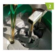
Komponente A sorgfältig aufrühren. Komponente B vollständig in Komponente A einmischen, bis eine homogene Abmischung entstanden ist.
